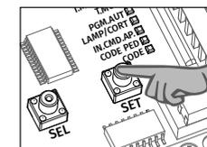
**02** • Presione la tecla **SET** por 1 segundo, para que el motor inicie la apertura.
