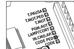
**03** • El **LED CODE PED** queda permanentemente aceso, señalizando el éxito de la programación.
