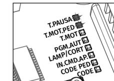
02 • Los LEDs **T.MOT. PED** y **T.PAUSA** comienzan a parpadear de forma alterna.
