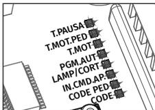
**02** • Todos los LEDs van a encender en simultáneo y de seguida borran, concluyendo la operación.
