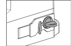
**01** • Desbloquee el motor, coloque el portón a medio curso y bloquee nuevamente el motor.
