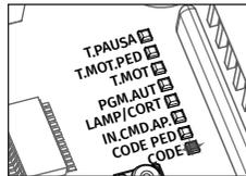
**03** • El LED **CODE PED** queda permanentemente aceso, señalizando el éxito de la programación.
