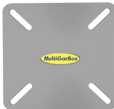
PLACA A1-A2, placa de acero con taladros colisos para abrazadera. Dimensión 240x240x8mm
