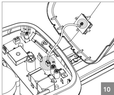
• Para cambiar la placa de LEDs debe abrir la tapa superior y desencajar los cables de los LEDs de la central de control. Destornille los tornillos que cogen la placa de LEDs a la tapa superior y retire la placa. Ahora basta colocar la nueva placa de LEDs, atornilla-la, encaja el cable en la central de control y vuelve a encajar la tapa al motor.
