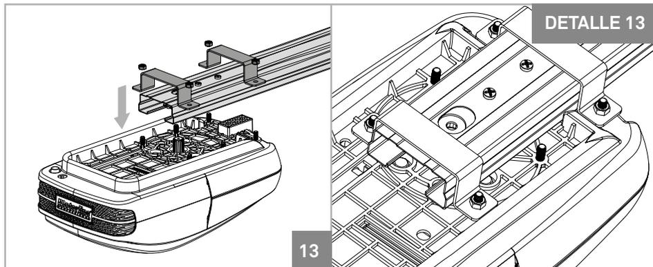
01 • La fijación de la guía de hierro en el automatismo debe ser hecha utilizando las chapas y las tuercas M6, como se muestra en la imagen de arriba. Debe apretar en cuatro tornillos, dejando los dos del medio libres.
