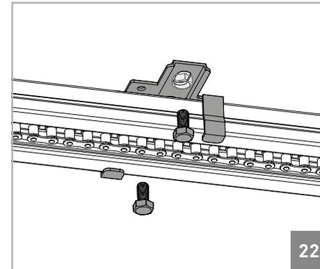
**05 •** Despues de subir la guía y marcar los agujeros, debe fijar la chapa con los tornillos. A seguir, debe reforzar la fijación con abrazaderas, de esta vez, cerca del motor (imagen 23).
