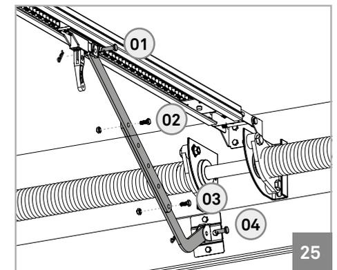
**07 •** Fije ahora las dos chapas de enlace entre el carro y la chapa del panel superior. Utilice los tornillos y tuercas M8 para apretar las dos chapas entre si (02 y 03), y los dos pines con tornillos para fijar en el carro y portón (01 y 04).
