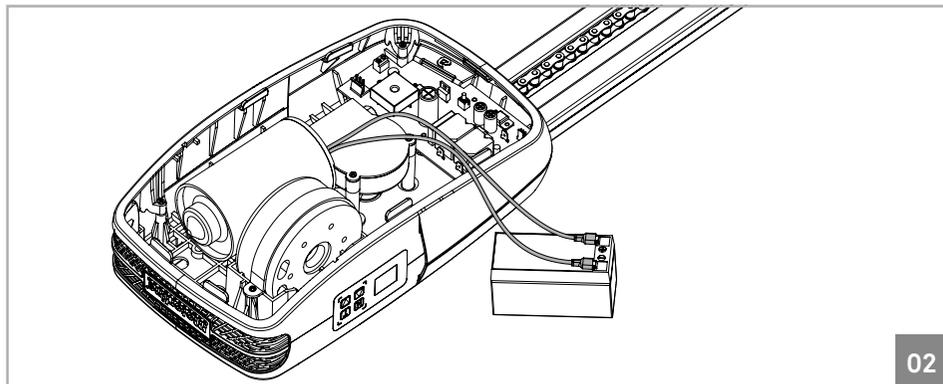
Los cables del motor no tienen sentido específico de conexión. La única diferencia es que conectándolo de una forma ira a rodar en un sentido, y al contrario ira a rodar al otro.
