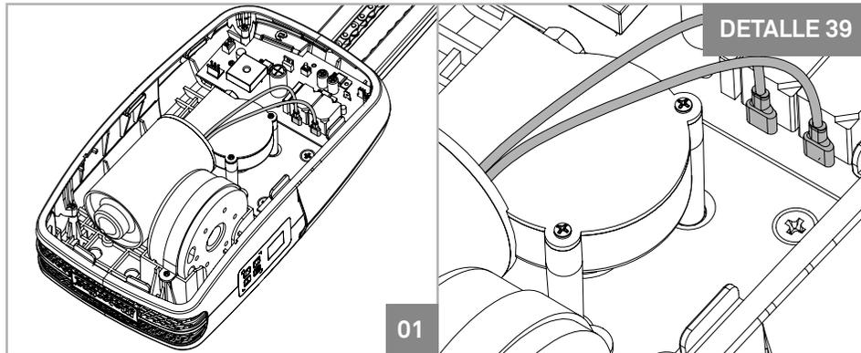
En caso de avería o mal funcionamiento del automatismo, será necesario detectar el componente averiado (motor o central). Para tal debe TESTAR el motor conectado directamente a una fuente de alimentación a **24V DC**, de manera que se pueda ver si este funciona. Basta desconectar los dos cables del motor ( como muestra la imagen 39) que son lo que hacen la conexión a la central, y conéctalos directamente a una batería de **24V DC**, como muestra el dibujo 40.
