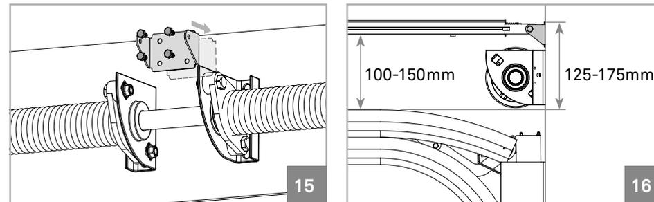
01 • Fijar la chapa del soporte de la guía al dintel, como muestra la imagen 15. En la imagen 16 se puede ver la distancia a mantener entre la guía del portón y la parte superior de la chapa del soporte (125-175mm).
