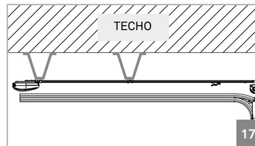
← Nota • En caso que no pueda fijar la guía al techo por no respetar las medidas de encima, debe crear una estructura sólida para poder fijarla en las medidas correctas, esa estructura podrá ser fijada en el techo como muestra la imagen 17.
