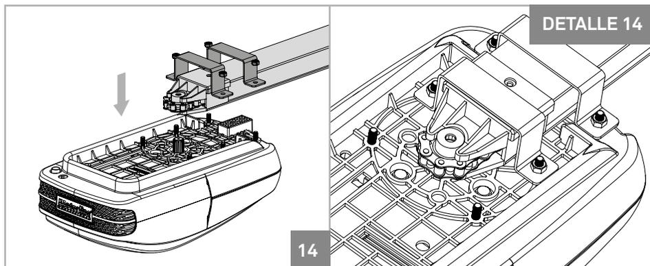
02 • La fijación en la guía de aluminio debe ser hecha utilizando las chapas y las tuercas M6, como muestra en la imagen de arriba. Debe dejar los dos de enfrente libres.
