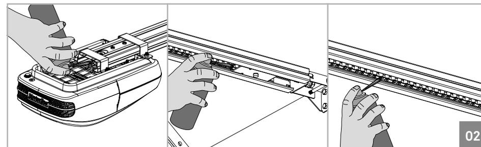
El único mantenimiento necesario es la lubricación de los ejes de movimiento de del automatismo y de la guía. Los piñones en los dos extremos de la guía, así como los soportes de rodamiento que devén ser lubricados como mínimo una vez por año.
