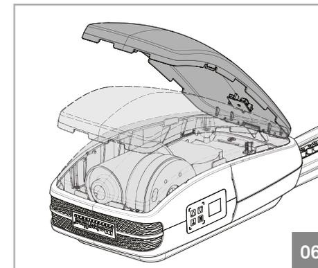
Para retirar la tapa, basta con introducir un destornillador en los tornillos laterales, y crear un efecto palanca para soltar los encajes entre la tapa superior y el cuerpo. Después basta retirar la tapa.
