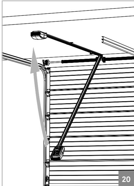
**04 •** Suba el motor hasta que la guía quede nivelada horizontalmente. En caso que sea necesario debe crear una estructura de apoyo a una superficie solida como se muestra en la pagina anterior, de manera que la guía quede anivelada (imagen 17).
