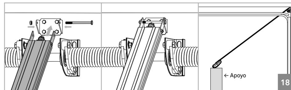
02 • Apretar la guía en la chapa de fijación ya colocada. Para facilitar la tarea puede hacerlo con la guía inclinada (motor apoyado en el suelo) lo que facilita la instalación pues solo tiene que tocar la zona donde va fijada la guía.
