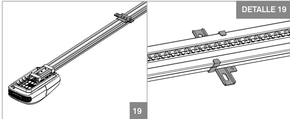
**03 •** Colocar chapa de fijación de la guía al techo sensiblemente al medio de la guía de hierro, como se ve en la imagen.
