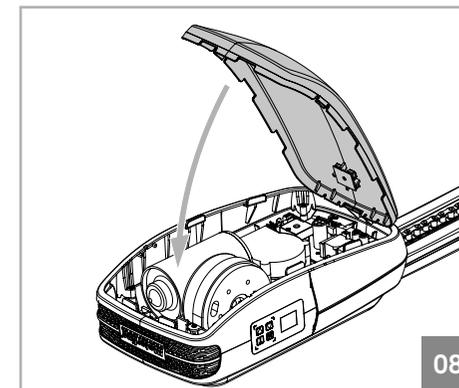
Para colocar la tapa, debe primero encajar la parte trasera como se ve en el diseño 07 después basta con encajar la parte frontal empujando hacia abajo. Los encajes encajaran automáticamente.
