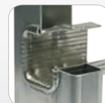
Peldaños fijados a los montantes con doble ensanchamiento hidráulico rebordeado. SIN REMACHES
