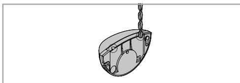
**04.** El radar posee dos salidas de cable por la parte superior. con el radar serrado escoja uno, y con la ayuda de una broca, abra y pase el cable.
