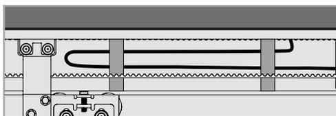
**06.** Por fin, estire y fije el cable dentro del cofre de la puerta, de manera a que este no interfiera en el movimiento de otros componentes como correa o carro.
