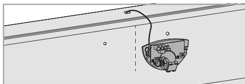
**03.** Haga pasar el cable por el agujero y conéctelo al conector existente en el interior del radar y en la placa de conexiones en el interior del cofre (esquema de conexiones).
