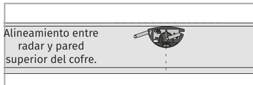
**01.** Coloque el radar centrado con la marca central de la tapa del cofre, y alineado con la parte superior y proceda a marcar y a agujerear.
