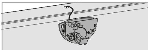
**05.** bueva abrir el radar y fíjelo en los agujeros hechos anteriormente, coloque nuevamente la tapa frontal. El cable deberá pasar por el agujero realizado en la parte superior del radar punto (04).
